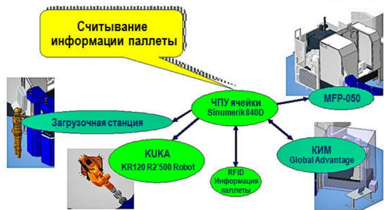
Рис. 11. Фрагмент цикла работы роботизированной ячейки
