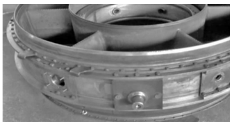
Рис. 6. Деталь со сложными конструктивными элементами, формообразование которых оптимально осуществлять методом лазерной наплавки
