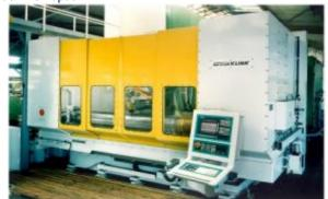
В комплекс входит: - станок для заточки протяжек **Arthur Klink RSB 1600** имеющий возможность заточить все режущие и вспомогательные кромки протяжки без переустанова;
