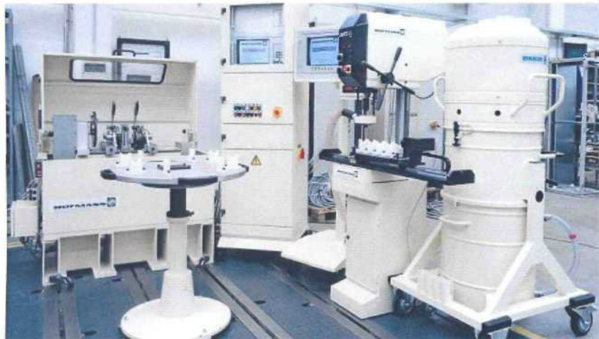
Ручная балансировочная машина для коленчатых валов R2, R3- и R4.
