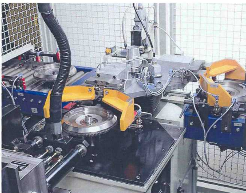
Автоматическая балансировочная машина для маховиков.
