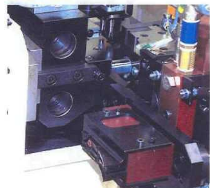
Устройство для подачи-передачи и сварочный электрод
