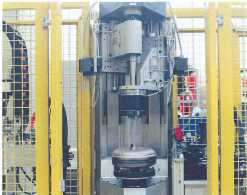
Гибкая балансировочная машина - преобразователь для легковых автомобилей.
