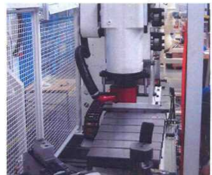
Фрезеровочное устройство с корпусом отсоса и зажимным устройством
