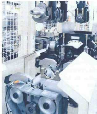
двух станционная балансировочная машина для коленчатого вала R4.
