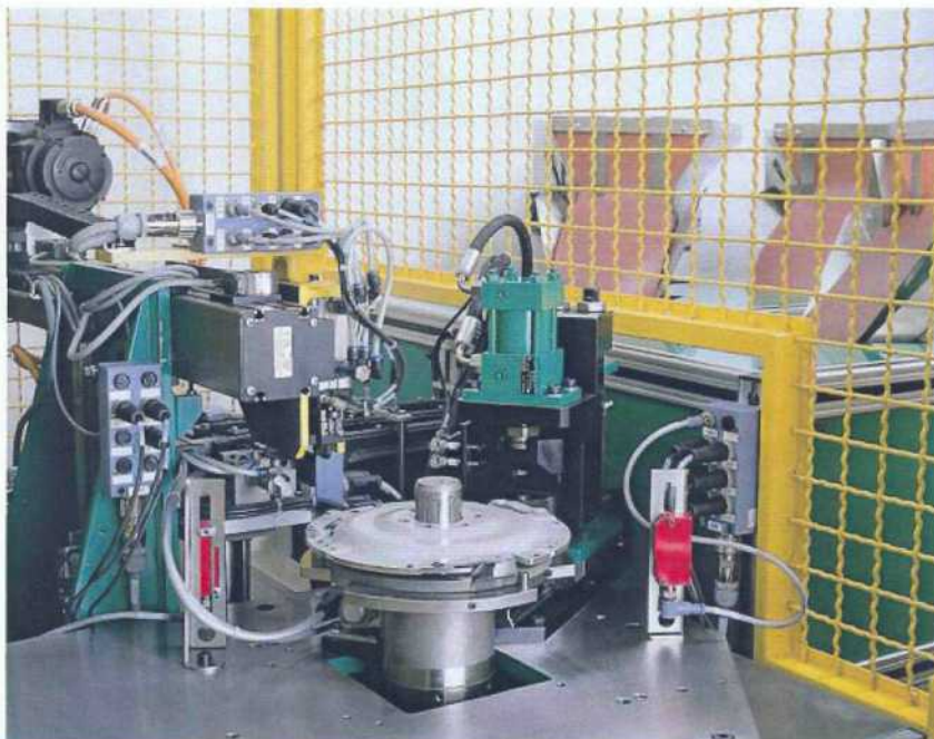
Автоматическая балансировочная машина для дисков сцепления с гидравлической единицей сцепки.
