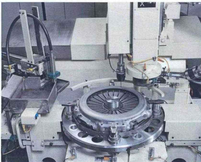
Автоматическая балансировочная машина для диска сцепления грузовых автомобилей.
