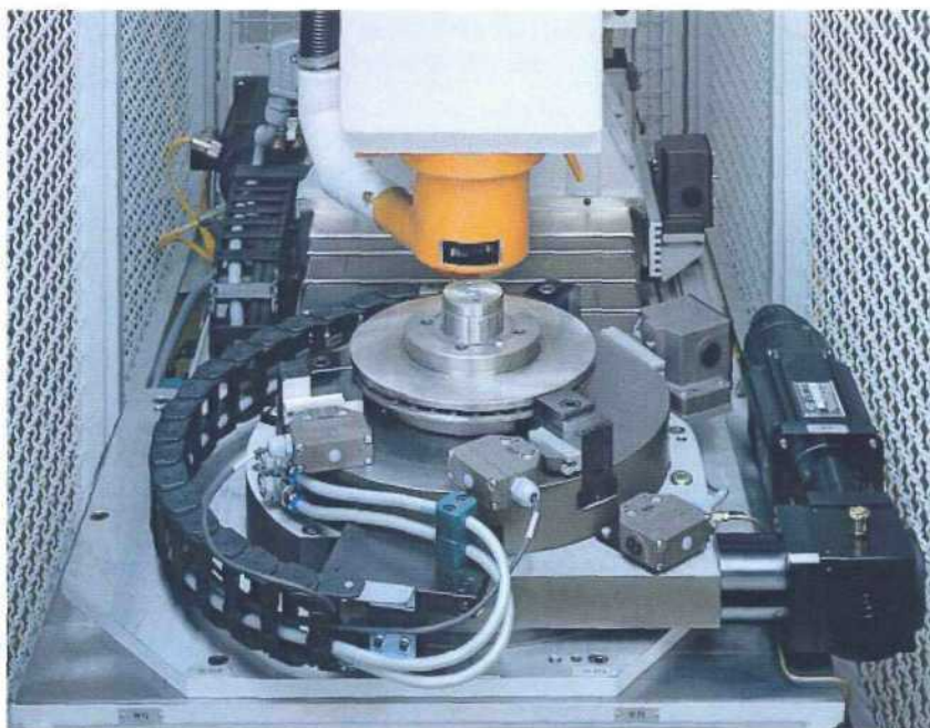
Балансировочная машина с ручной загрузкой для тормозных дисков.
