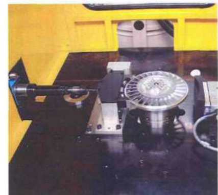
Сверлильное устройство с держателем
