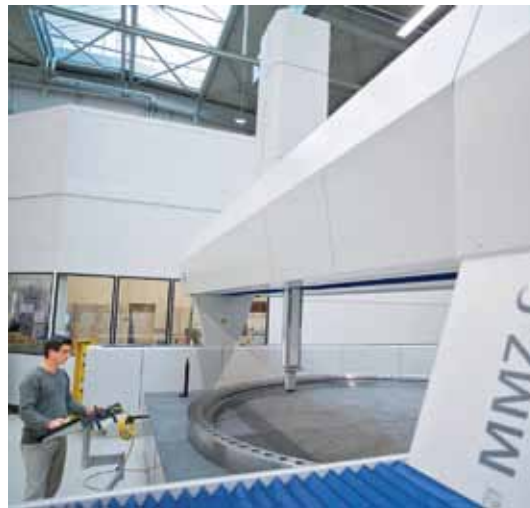
Комплекс ZEISS MMZ G 60/60/16 в компании ThyssenKrupp Rothe Erde, Липпштадт (Германия)
