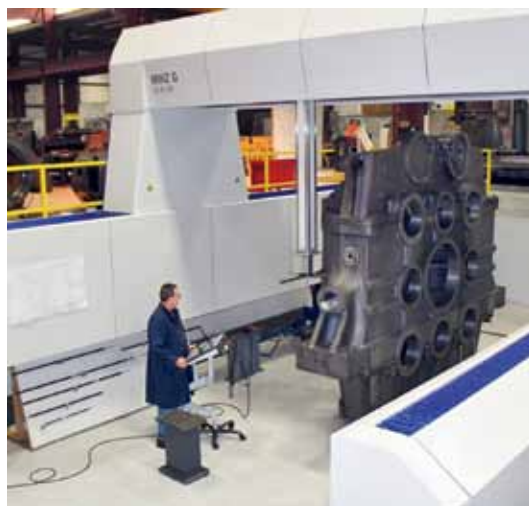
Комплекс ZEISS MMZ G 40/60/30 в компании Three-M Tool and Machine, Inc., Висконсин, Мичиган (США)
